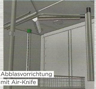
Abblasvorrichtung mit Air-Knife
