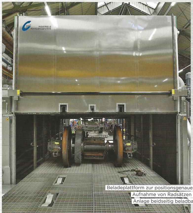
Beladepattform zur positionsgenauen Aufnahme von Radsätzen - Anlage beidseitig beladbar
