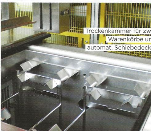
Trockenkammer für zwei Warenkörbe und automat. Schiebedeckel
