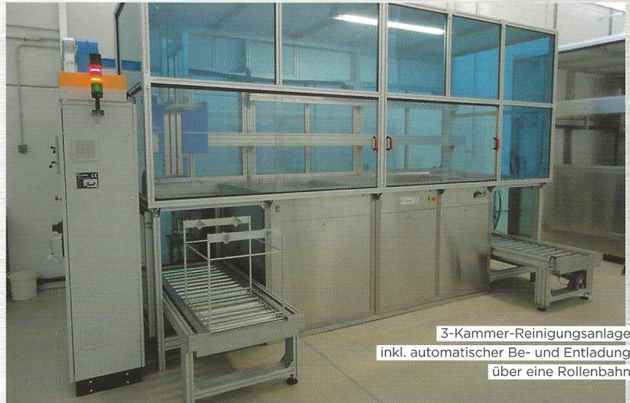
3-Kammer-Reinigungsanlage inkl. automatischer Be- und Entladung über eine Rollenbahn
