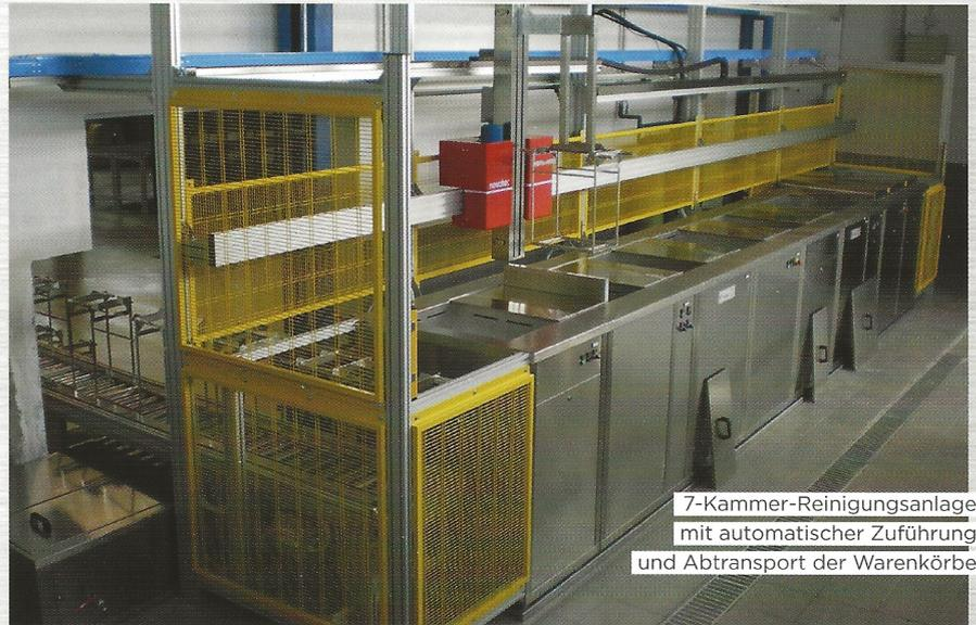
7-Kammer-Reinigungsanlage mit automatischer Zuführung und Abtransport der Warenkörbe
