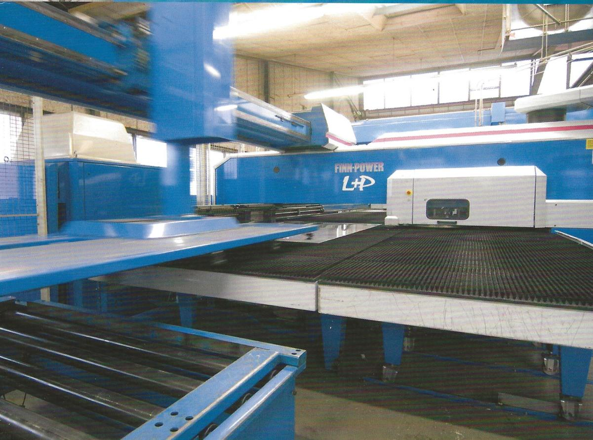
Le coeur de la production de Sablux. Centre de presse au laser entièrement automatique Finn-Power LP6.
