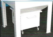
L'installation de filtrage de type IS 852 complète le concept d'installation, et est adaptée aux installations de sablage SX 90 S à SX 155 S. Outre le nettoyage manuel du filtre en appuyant sur un bouton à l'aide de la réserve pression intégrée, le tiroir à poussière simple à monter est compris également dans le modèle standard.
