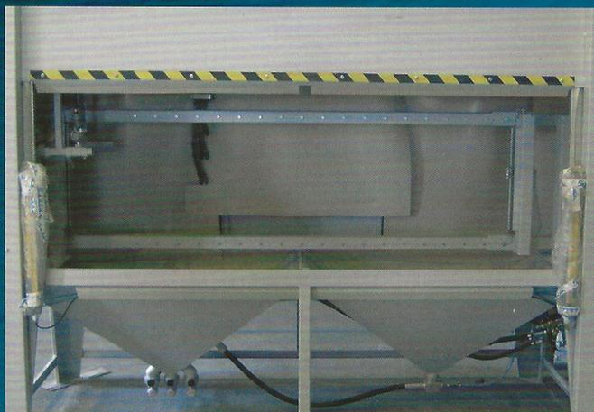
Cabine de sablage SX 270 S avec voies horizontales et verticales sur le toit de la cabine.
