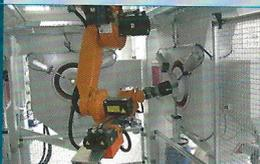
Les pièces à usiner peuvent être travaillées dans plusieurs étapes de travail avec différents abrasifs telle est la solution proposée par cette installation avec portail. Un robot vissé sur la tête garantit le déroulement du processus.
