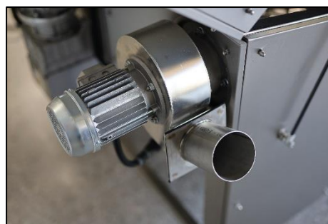
Dampfschwadenabsaugung mit Kondensatrückführung
